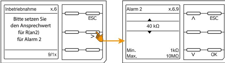
Nachdem Sie den Ansprechwert  $R_{an2}$  für Alarm 2 eingestellt haben, startet das Gerät einen Selbsttest, danach die initiale Messung und anschließend die Ausgabe des ermittelten Isolationswiderstandes des überwachten IT-Systems und die Inbetriebnahme ist abgeschlossen.
