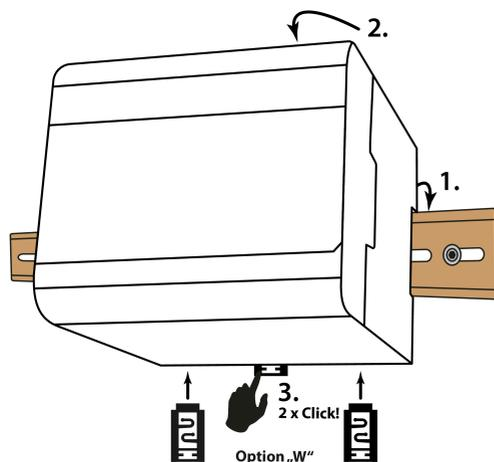
1. Gerät auf der Hutschiene einhängen.
