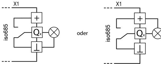
**Passiv** Im passiven Modus werden extern  $\leq 32$  V angeschlossen (siehe Technische Daten). Der Ausgang schaltet das angelegte Potential auf Masse.
